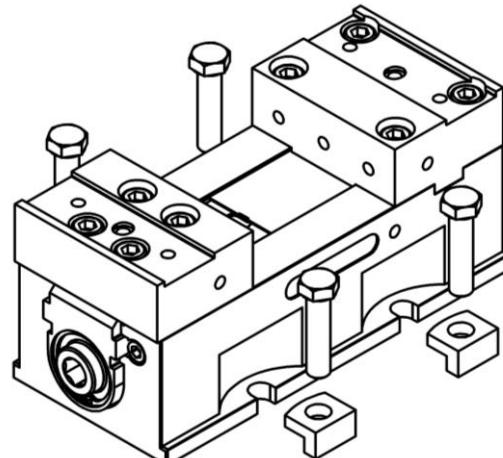
In der Grundausführung sind 4 x Ø12 H7 Positionierbohrungen vorhanden, mit denen der KSO auf Rasterplatten mit 50er Teilung, sowie in T-Nut Tischen positioniert werden kann. Der KSO wird mit 4 Zyl.-Schrauben M12 x 50 und 4 Spannpratzen von oben befestigt.
