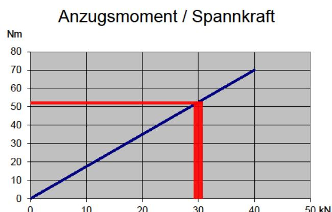
Beanspruchungen über dem max. Anzugsmoment führen zu Schäden an der Spindel.
